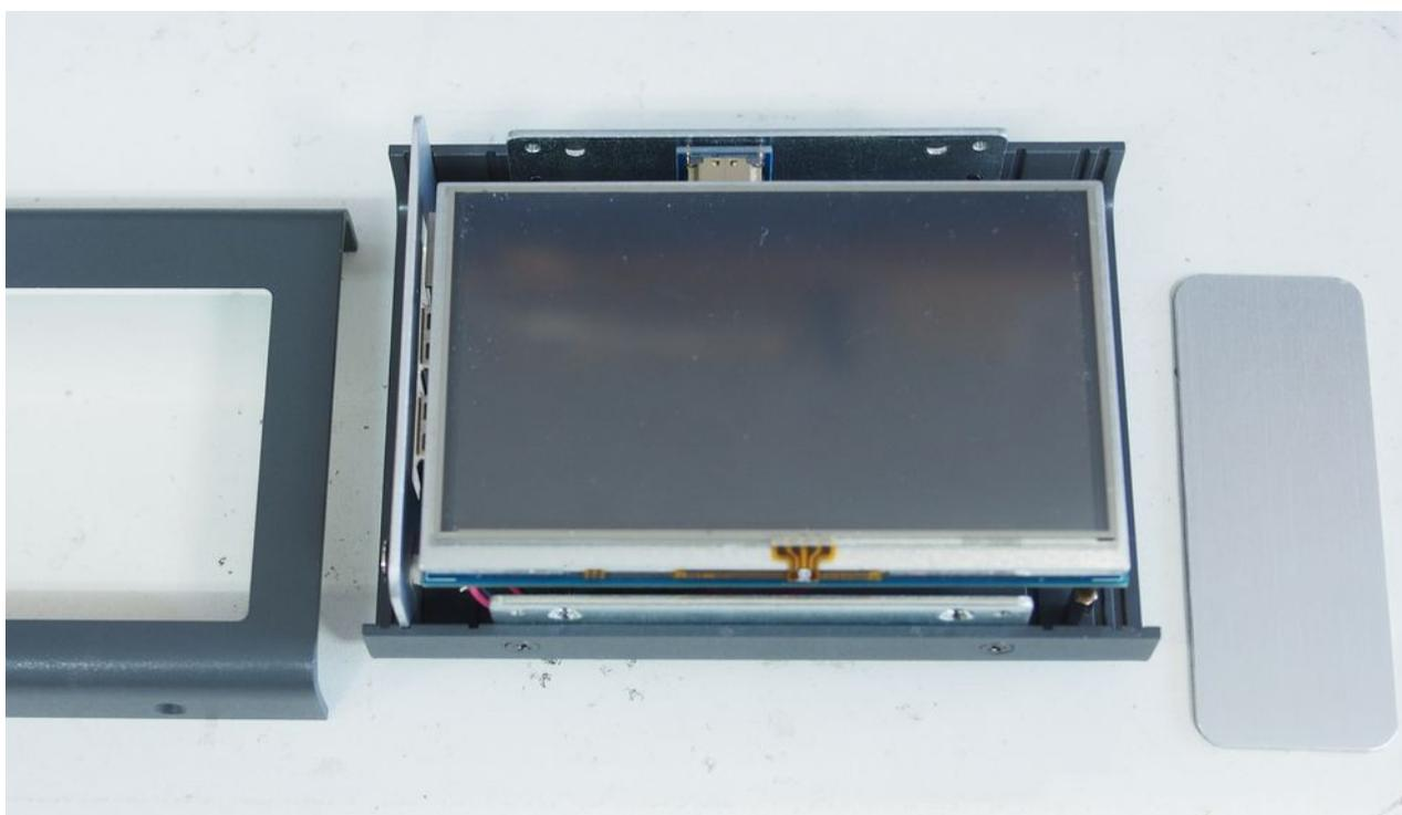
3 中に SD カードが見えますので、手をつっこみ抜き取ります。一度軽く押し、反動で抜き出したところを引き出します。
