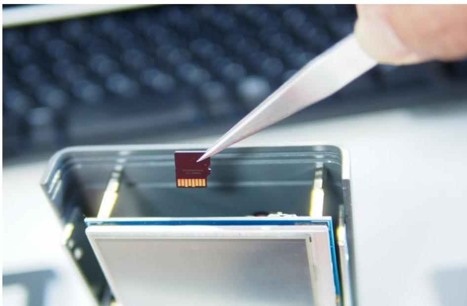
5 ピンセットでSDカードを差し込んだら、指で軽く押し、SDカードを完全に挿入します。
